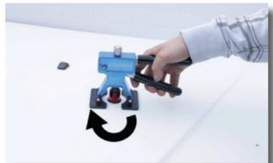
Mit dem Gleithammer senkrecht zum Adapter mit tastenden, dann härteren Schlägen die Delle etwas zu weit herausziehen, sodass eine Beule entsteht.
